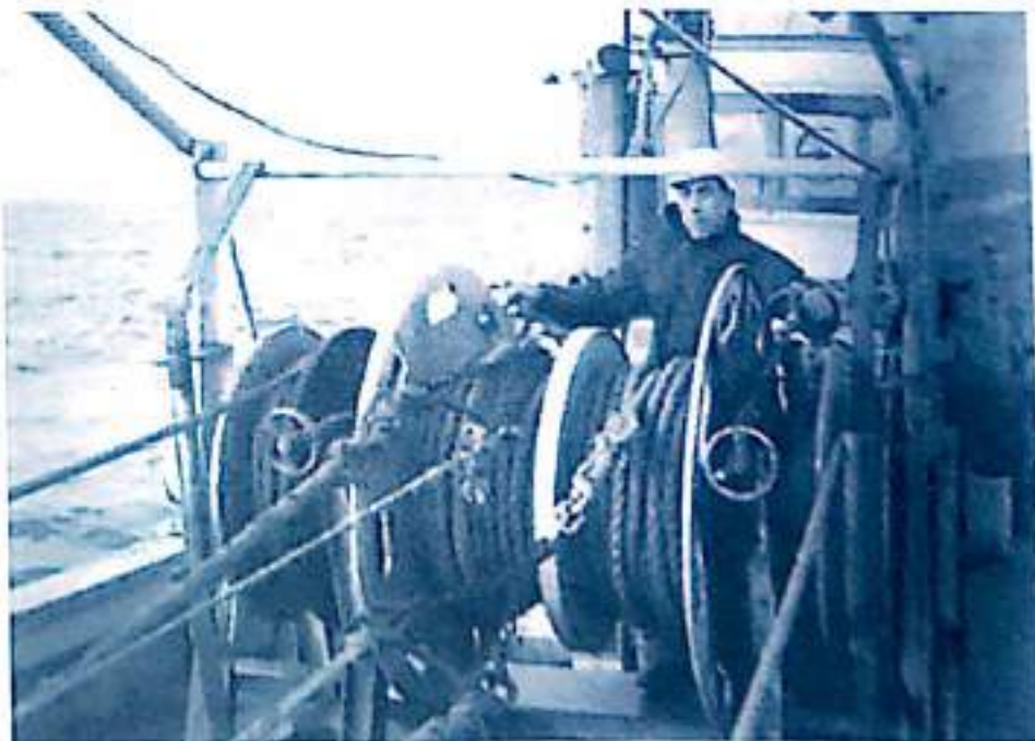
Gambar 7.6 Winch sebagai alat bantu penangkapan ikan pada alat tangkap trawl (BSNI, 2008).
