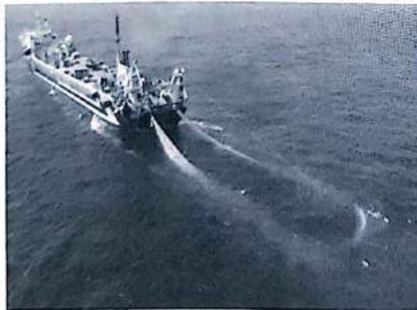
Gambar 7.8 Sepasang gallow yang dipasang pada tiang buritan ( stern mast ) yang berfungsi sebagai blok pengamat warp dari otter board ke winch .
